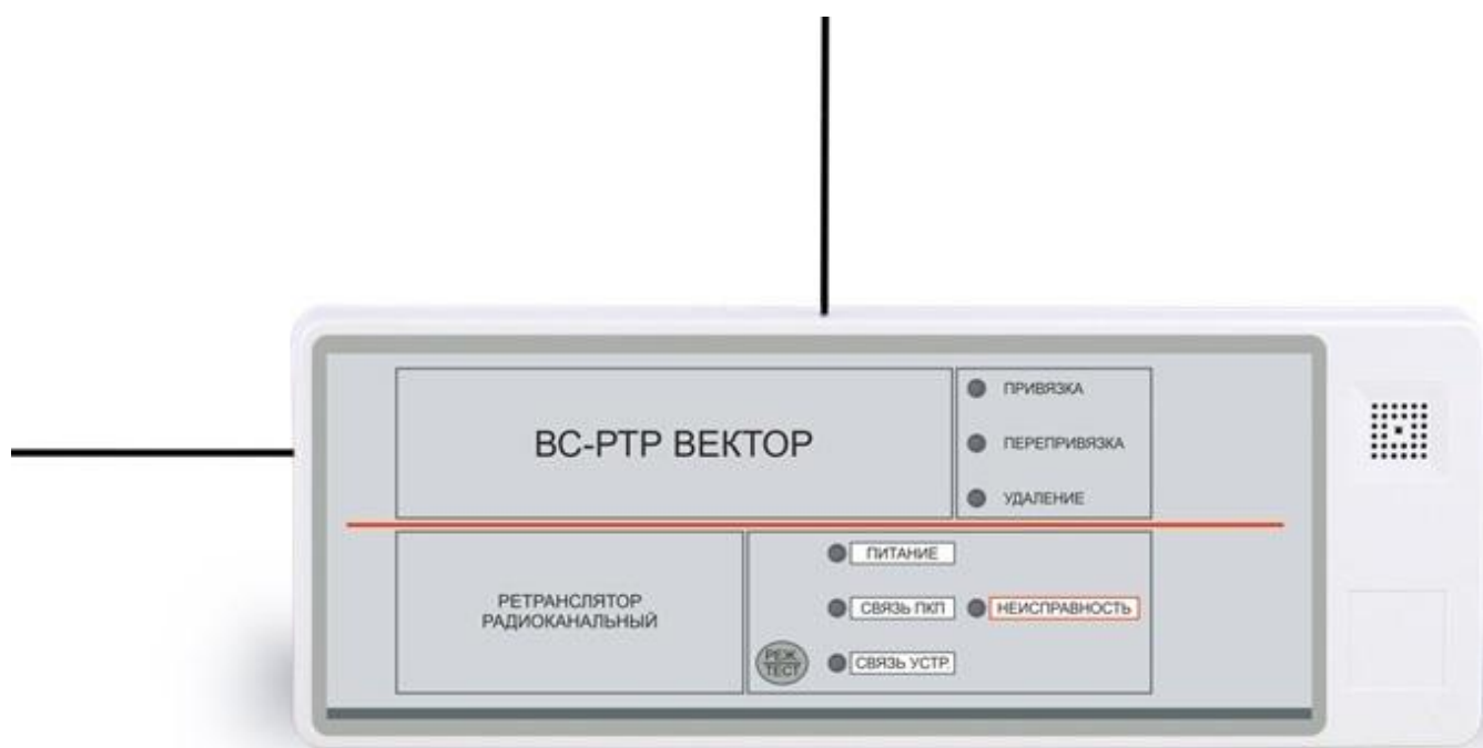
Рис. 1. Внешний вид ретранслятора радиоканального «ВС-РТП ВЕКТОР»
