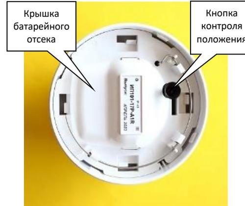
батарей извещателя. Резервная батарея установлена и готова к работе.
