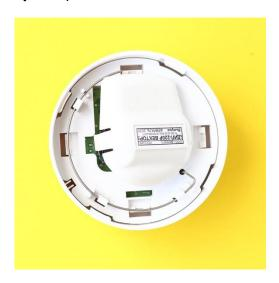
2.2. Отведите отверткой 4 защелки в корпусе:
