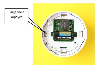
2.3. Извлеките основание с печатной платой и дымовой камерой из корпуса.
