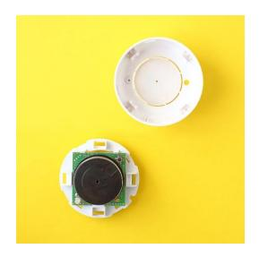
2.4. Снимите защитную сетку с дымовой камеры, с усилием потяните за крышку дымовой камеры, чтобы отделить ее от основания:
