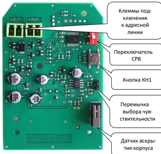
**Внимание!** При проверке извещателя кнопкой «КН1» кнопка «Тампер» должна быть зафиксирована в нажатом состоянии.
